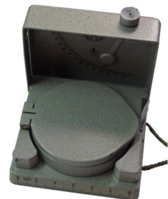
Universalkompass mit geschlossenem Spiegel und arretierter Nadel
