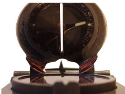
Visierung über Zeileinrichtung und Visierschlitz
