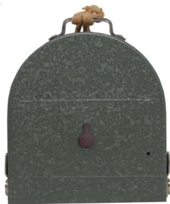
*der Gehäusedeckel mit Direktionspfeil und der Möglichkeit den Kompass im Gelände zu befestigen*
