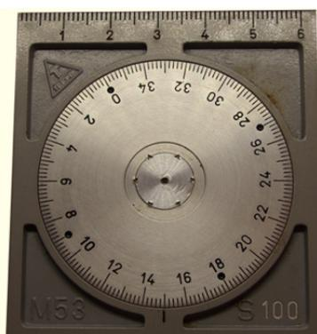
Ablesung der Marschrichtung in Grad auf dem Gehäuseboden
