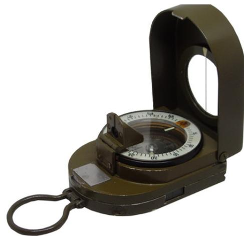
Bei manchen Modellen haben wir einen seitlichen Neigungsmesser in das Metallgehäuse eingearbeitet. Mit einem Knopfdruck wird die Arretierung gelöst und man kann Steigungen bzw. Gefälle messen. Bei meinem Modell ist das leider nicht der Fall. Hier gibt es im Gehäuse seitlich eine Aussparung.
