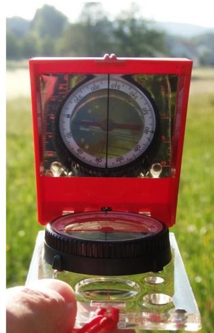
*Anvisieren von Geländepunkten mit gleichzeitiger Ablesung der Skala*
