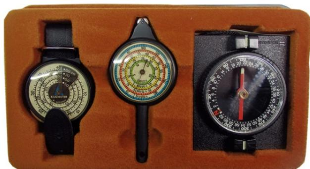
Es handelt sich bei dem Kompass um ein preiswertes Einsteigermodell aus einem schlagfesten Kunststoffgehäuse. Es gibt eine kombinierte Skala mit 360 Grad und 64-00 Strich. Die Nadel wurde bei Eschenbach bereits auf einem Saphir gelagert und nicht mehr auf einem Achat. Die Skala war nachleuchtend und nicht mit einem Fluid gefüllt.
