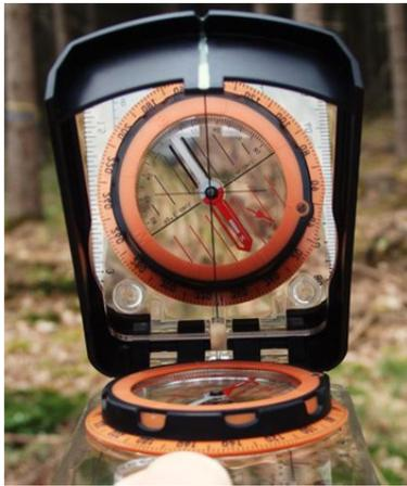
*Deckel in 45 Grad Stellung als Winkelunterstützung für die Spiegelkompassfunktion*
