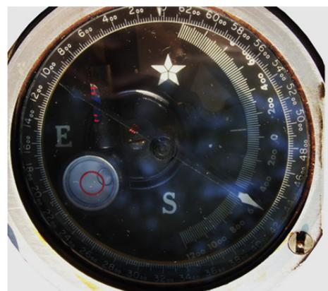
Peilen wir also ein Ziel an, so lesen wir den Gegenrichtungswinkel ab. Das bestimmt nun die Thematik eines Artilleriekompasses. Weiterhin können wir mit der Röhrenlibelle und der zweiten Skala in der Kompasskapsel eine Steigung bzw ein Gefälle messen. Das Gehäuse des Kompasses ist nicht rund, sondern hat seitliche gerade Anlegekanten. Mit diesen können wir den Kompass auf das Geschützrohr setzen und mittels der Röhrenlibelle diese in die horizontale Ebene
