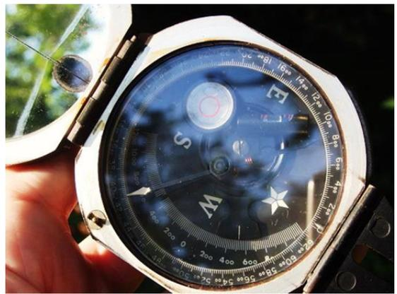
*Ermittlung der Steigung mittels der Libelle und des Neigungsmessers*
