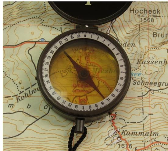
Es gibt eine verstellbare Missweisungskorrektur, der Metallskalenring ist drehbar. Daher kann der Taschenkompass als Marschkompass verwendet werden. Mittels des transparenten Kapselbodens und der fünf Ost-West-Linien kann man diesen Kompass auch als Kartenkompass verwenden.
