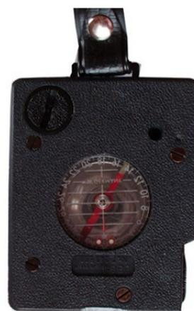
*Gehäuseboden mit Missweisungspfeil und Batteriefach*
