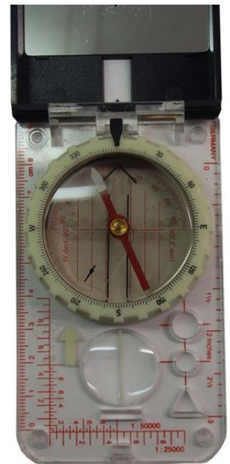
Transparente Grundplatte mit thermoelastischer Fluidkapsel
