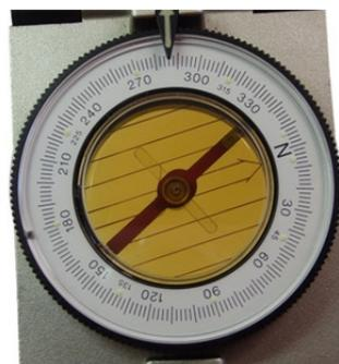
*Teilring mit transparenter Kompasskapsel*
