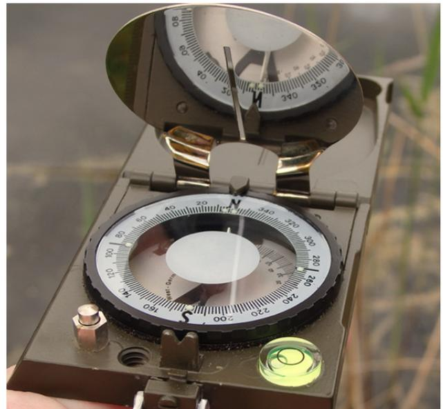
*Marschkompass mit trockener Kompasskapsel und linksdrehender Skala*
