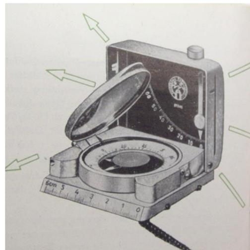
*Steigungen und Gefälle werden durch den Schlitz anvisiert und über den Inklinometer abgelesen*
