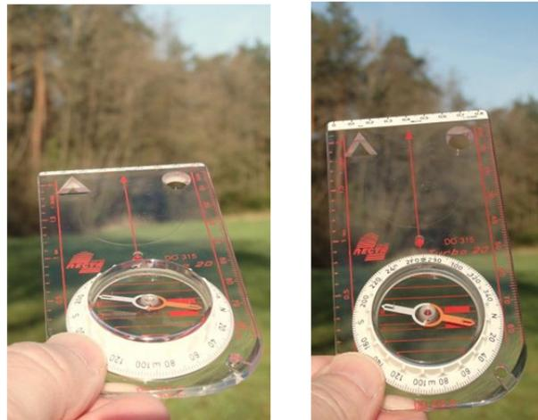
*Anvisieren des Zieles durch Kippen des Kompasses von der horizontalen in die vertikale Ebene*
