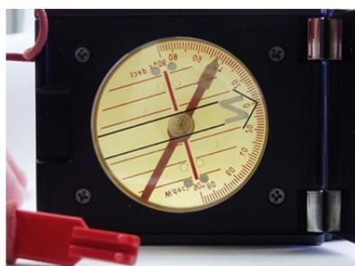
Deklinationsskorrektur mit Verstellmechanismus
