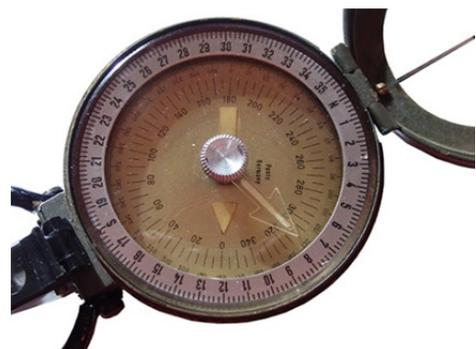
*Skala 360 Grad auf der Kompassrose und auf dem äußeren Teilring*
