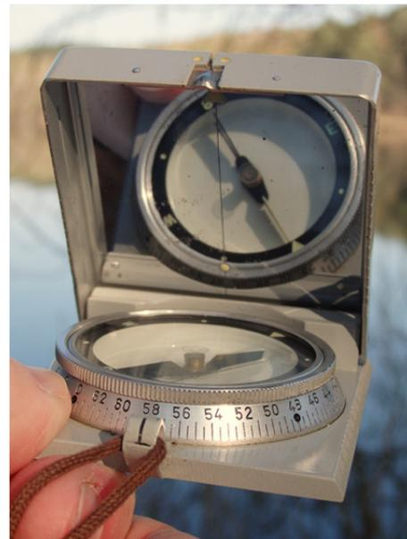
*Die Balkennadel wird in N-S-Linie in Übereinstimmung gebracht*
